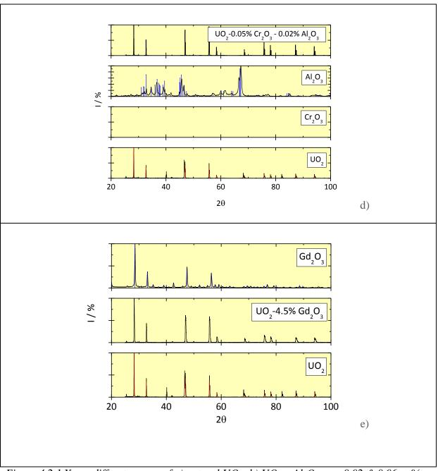
Figure 4.2.1 X-ray diffractograms of a) natural  $UO_2$ ; b)  $UO_2$ -  $xAl_2O_3$ ; x = 0.02 & 0.06 wt%; c)  $UO_2$ - $xCr_2O_3$ ; x = 0.02 & 0.06 wt; d)  $UO_2$ - $0.05 wt\%Cr_2O_3$ - $0.02 wt\% Al_2O_3$  and, e)  $UO_2$ - $4.5 wt\% Gd_2O_3$  disc fabricated at CIEMAT.
