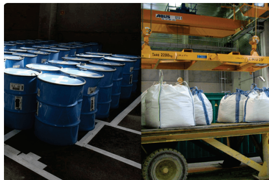
Fig. 1.6 – Fûts métalliques et big-bags de déchets TFA manutentionnés au Cires [Andra b].
