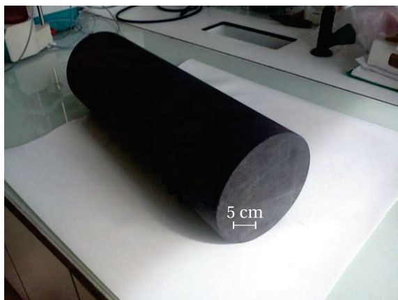
Fig. 3.1 – Rondin de graphite nucléaire EDF provenant du dégavage des briques d'empilement de SLA2.
