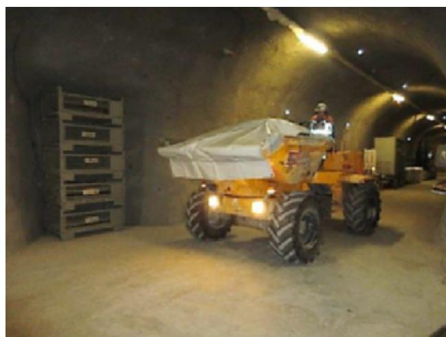
Fig. 15: Thweites 6tons dumper
